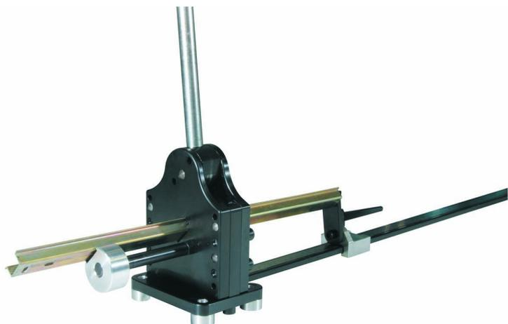
Das Profilschneidergerät TS-PS eco wurde zum manuellen Ablängen von DIN-Tragschienen TS 35 entwickelt. TS-PS eco arbeitet schnell, lautlos und gratfrei. Das Ergebnis ist ein gerader und feiner Schnitt ohne ein nicht gewolltes Verbiegen der Schiene zu erzeugen. Das System kann auf einer Werkbank bzw. ähnlichen Arbeitsplätzen montiert werden.
