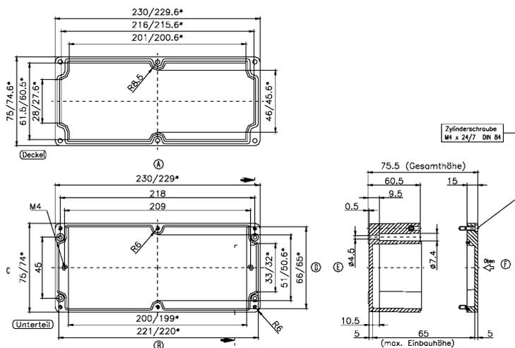
Glasfaserverstärktes Polyester-Gehäuse, Farbe: Fehgrau, RAL: 7000, Deckel: Duroplastischer Polyester, Fehgrau
