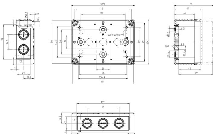
Polystyrol-Gehäuse, Farbe: Grau, RAL: Ähnlich 7035, Deckel: Polycarbonat, Transparent
