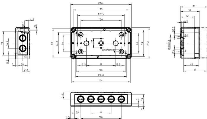
Polystyrol-Gehäuse, Farbe: Grau, RAL: Ähnlich 7035, Deckel: Polystyrol, Grau
