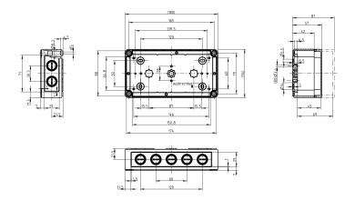
Polystyrol-Gehäuse, Farbe: Grau, RAL: Ähnlich 7035, Deckel: Polycarbonat, Transparent
