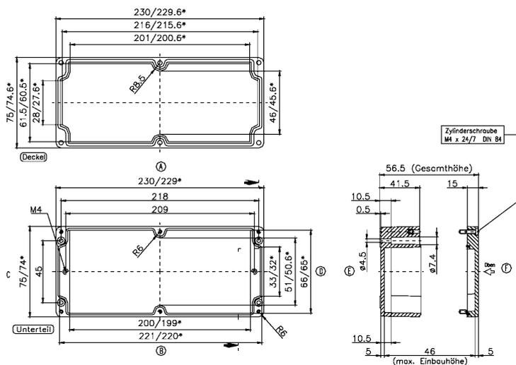
Glasfaserverstärktes Polyester-Gehäuse, Farbe: Fehgrau, RAL: 7000, Deckel: Duroplastischer Polyester, Fehgrau
