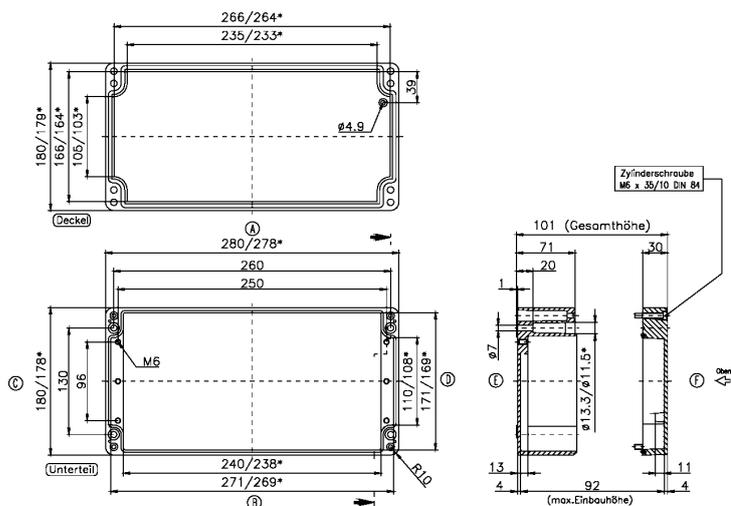
Aluminium-Gehäuse, Oberfläche: Pulverlackbeschichtung, Farbe: Silbergrau, RAL: 7001
