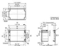
Glasfaserverstärktes Polyester-Gehäuse, Farbe: Fehgrau, RAL: 7000, Deckel:
