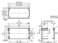
Glasfaserverstärktes Polyester-Gehäuse, Farbe: Fehgrau, RAL: 7000, Deckel:
