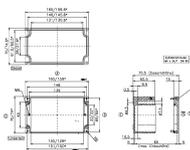
Glasfaserverstärktes Polyester-Gehäuse, Farbe: Fehgrau, RAL: 7000, Deckel: Duroplastischer Polyester, Fehgrau
