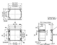
Glasfaserverstärktes Polyester-Gehäuse, Farbe: Fehgrau, RAL: 7000, Deckel: Duroplastischer Polyester, Fehgrau
