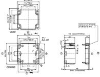
Polycarbonat-Gehäuse, Farbe: Lichtgrau, RAL: 7035, Deckel: Polycarbonat, Transparent
