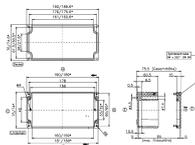
Glasfaserverstärktes Polyester-Gehäuse, Farbe: Fehgrau, RAL: 7000, Deckel:
