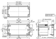
Polycarbonat-Gehäuse, Farbe: Lichtgrau, RAL: 7035, Deckel: Polycarbonat, Transparent
