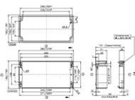
Aluminium-Gehäuse, Oberfläche: Pulverlackbeschichtung, Farbe: Silbergrau, RAL: 7001
