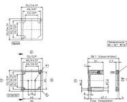
Glasfaserverstärktes Polyester-Gehäuse, Farbe: Fehgrau, RAL: 7000, Deckel:
