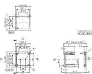
Glasfaserverstärktes Polyester-Gehäuse, Farbe: Fehgrau, RAL: 7000, Deckel:
