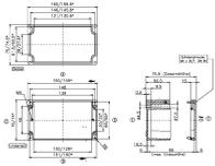
Glasfaserverstärktes Polyester-Gehäuse, Farbe: Fehgrau, RAL: 7000, Deckel:
