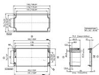
Glasfaserverstärktes Polyester-Gehäuse, Farbe: Fehgrau, RAL: 7000, Deckel: Duroplastischer Polyester, Fehgrau
