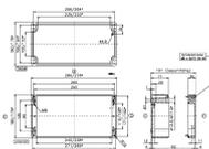
Aluminium-Gehäuse, Oberfläche: Pulverlackbeschichtung, Farbe: Silbergrau, RAL: 7001
