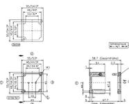
Glasfaserverstärktes Polyester-Gehäuse, Farbe: Fehgrau, RAL: 7000, Deckel:
