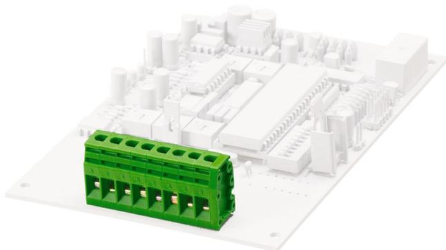
Printklemme, Schraubanschluss, Polzahl: 18, Breite: 92,5 mm, Farbe: Grün
