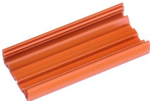
Strangprofil für Rastsockelsystem, Länge: 2000 mm, Unterteil, Breite: 46,5 mm, Leiterplattenbreite 42,5mm, Farbe: Orange, Hinweis: benötigte Profillänge = Leiterplattenlänge - 4 mm
