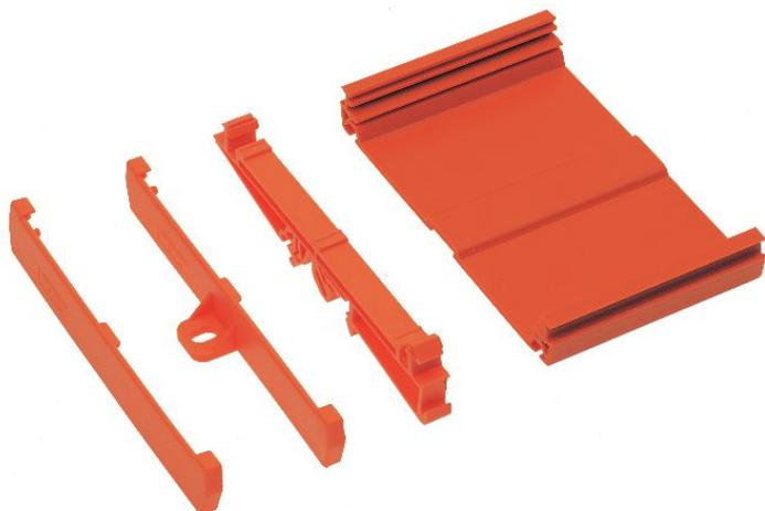
Strangprofil für Rastsockelsystem, Länge: 2000 mm, Unterteil, Breite: 119 mm, Leiterplattenbreite 100 oder 108 mm, Farbe: Orange, Hinweis: benötigte Profillänge = Leiterplattenlänge - 4,5 mm
