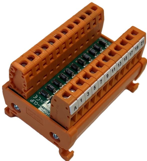
Dioden-Modul, mit 22 Dioden, gemeinsame Anode, Diodentyp 1N 4007, Schraubanschluss, Montageart: TS 35
