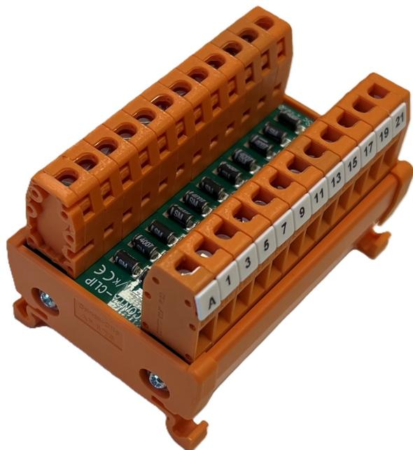
Dioden-Modul, mit 14 Dioden, gemeinsame Kathode, Diodentyp 1N 4007, Schraubanschluss, Montageart: TS 35
