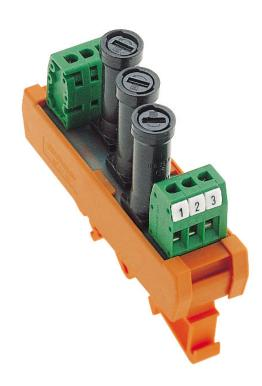
Sischerungs-Modul, 3 Sicherungseinsätze für 5x20 Feinsicherungen, gemeinsame Einspeisung, Schraubanschluss, Montageart: TS 35
