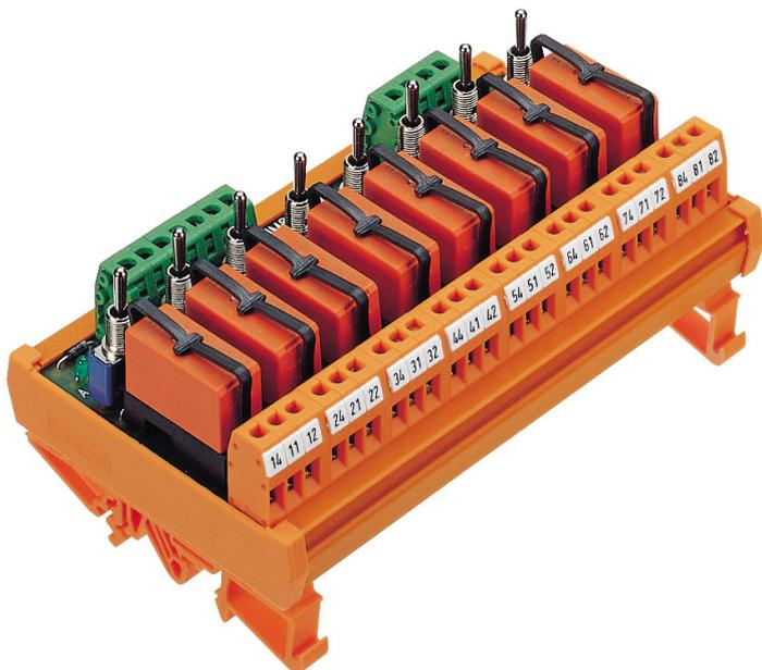
Mehrfach-Relaismodul mit Handbetätigung, Schraubanschluss, mit 2 Miniaturrelais, je 1 Wechsler, gesteckt, mit Leuchtanzeige, plusschaltend, Eingangsspannung: 24 VDC
