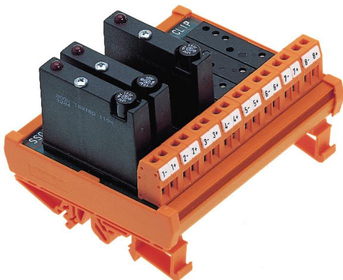
Mehrfach-Solid-State-Output-Module für G4 SSR Relais, Schraubanschluss, Montageart: TS 35, 8 Kanäle, minusschaltend, Lieferung ohne SSR Relais
