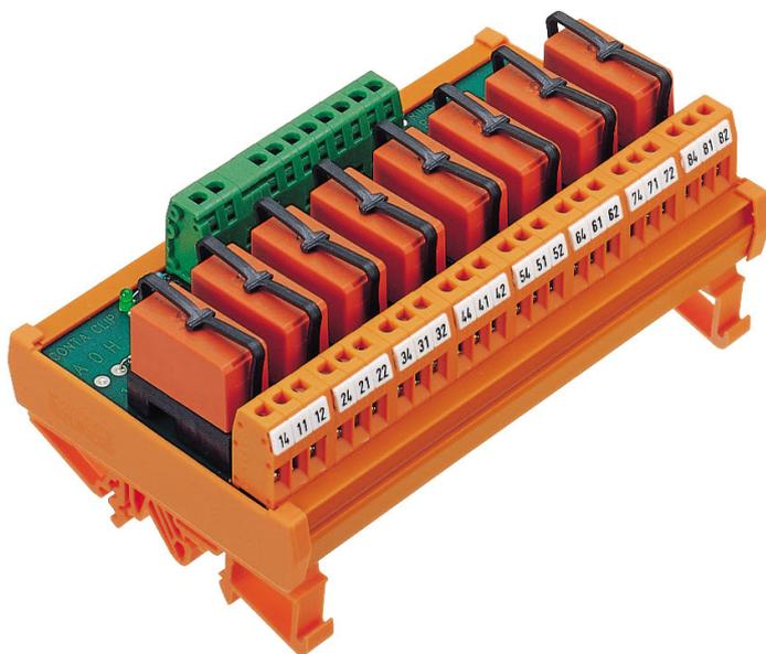
Mehrfach-Relaismodul, Schraubanschluss, mit 2 Miniaturrelais, je 1 Wechsler, gesteckt, mit Leuchtanzeige, plusschaltend, Eingangsspannung: 24 VDC
