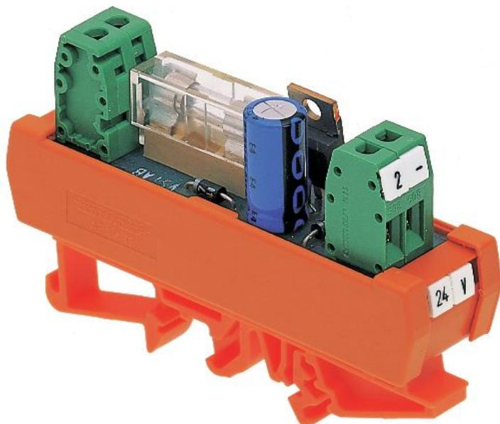
DC/DC Konvertermodul, geregelt, Schraubanschluss, Montageart: TS 35, Eingang: 1-phasig, Ausgang: 15 VDC/0,2 A
