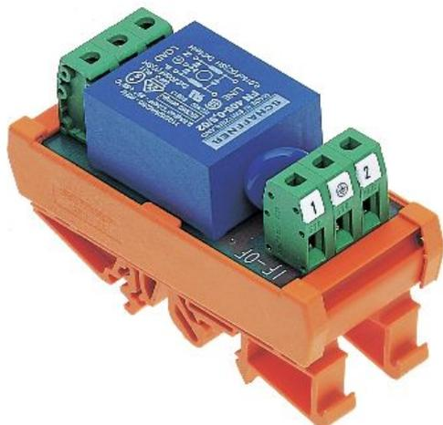
Entstörungsglied-Modul, Schraubanschluss, Montageart: TS 35, Unterdrückung von symmetrischen sowie asymmetrischen Störspannungen aus dem Netz, Überspannungsschutz durch integrierte Varistorbeschaltung, Betriebsspannung max.: 250VAC
