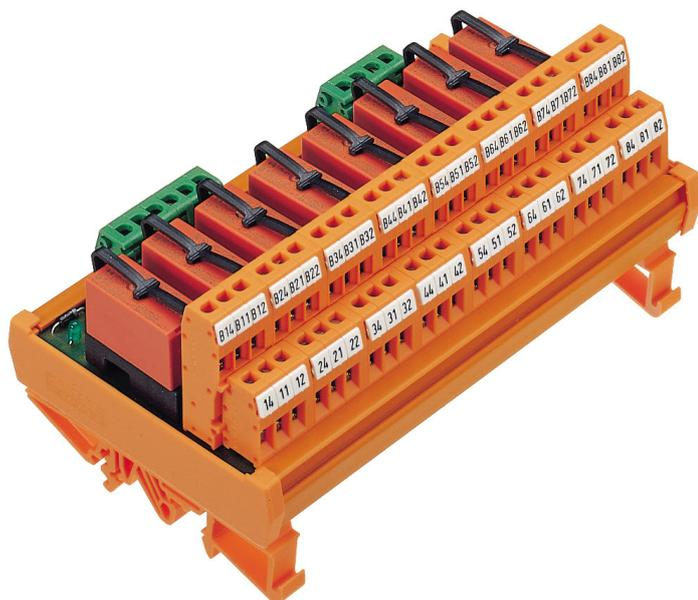
Mehrfach-Relaismodul, Schraubanschluss, mit 16 Miniaturrelais, je 2 Wechsler, gesteckt, mit Leuchtanzeige, getrennte Kanäle, Eingangsspannung: 115 VAC
