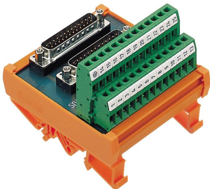
Übergabemodul für D-SUB, Schraubanschluss und 2x male D-SUB-Steckverbinder, Montageart: TS 35, Polzahl: 25
