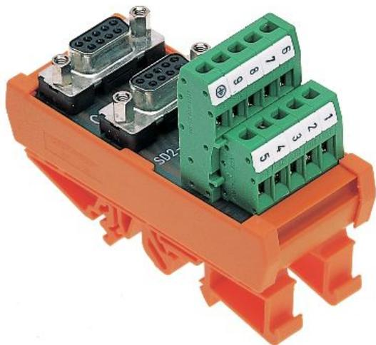
Übergabemodul für D-SUB, Schraubanschluss und 2x female D-SUB-Steckverbinder, Montageart: TS 35, Polzahl: 9
