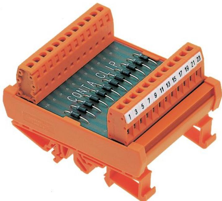
Dioden-Modul, mit 14 Dioden, einzeln beschaltbar, Diodentyp 1N 4007, Schraubanschluss, Montageart: TS 35
