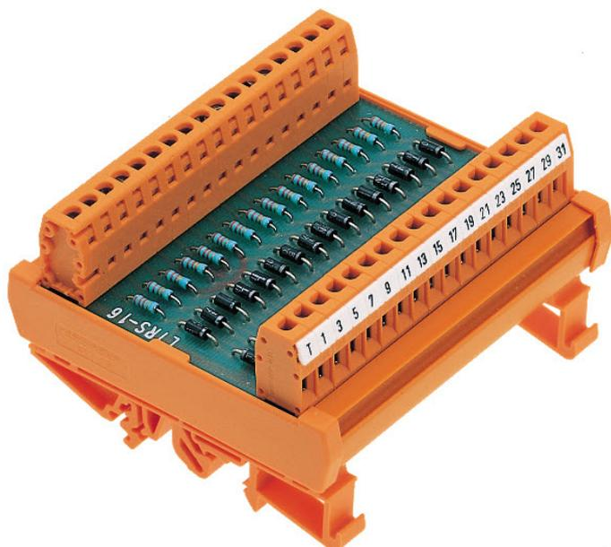
Lampenprüf-Modul, mit 32 Dioden in 16 Paaren mit gemeinsamer Kathode mit Widerstand, Diodentyp 1N 4007, Schraubanschluss, Montageart: TS 35
