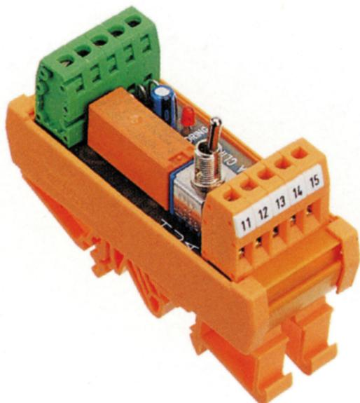
Digitales Schaltmodul mit Hand-Aus-Automatik Umschaltung, Schraubanschluss, Montageart: TS 35, 1 Kanal, Spannung: 24VAC/DC
