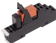
Vormontiertes Relaismodul PRS..., Zugfederanschluss, bestehend aus: Relaissockel, Leistungskontaktrelais, steckbarem Anzeige-/ Entstörmodul und Haltebügel, 1 Wechsler, Eingangsspannung: 24 VAC
