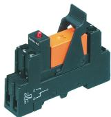
Vormontiertes Relaismodul PRS..., Schraubanschluss, bestehend aus: Relaissocket, Leistungskontaktrelais, steckbarem Anzeige-/ Entstörmodul und Haltebügel, 1 Wechsler, Eingangsspannung: 230 VAC
