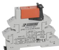
Plug-Relais-Compact (PRC) Stecksocket PRC mit Zugfederanschluss, Montageart: TS 35, 2 Wechsler, Eingangsspannung: 6,12 oder 24 VAC/DC
