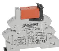
Plug-Relais-Compact (PRC) Komplett, bestehend aus Sockel PRC... mit Zugfederanschluss und steckbarem Miniaturrelais PRS... mit Leistungskontakt, Montageart: TS 35, 2 Wechsler, Eingangsspannung: 24 VAC/DC
