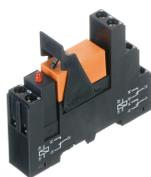
Vormontiertes Relaismodul PRS..., Schraubanschluss, bestehend aus: Relaissocket, Leistungskontaktrelais, steckbarem Anzeige-/Entstörmodul und Haltebügel, 2 Wechsler, Eingangsspannung: 24 VDC
