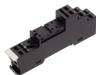
Relais-Stecksockel PRS, für Miniatur-Leistungserelais mit 2-Wechslern, Zugfederanschluss, Steckmöglichkeit für Eingangs-/Entstörmodule, Montageart: TS 35
