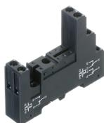
Relais-Stecksockel PRS, für Miniatur-Leistungserelais mit 2-Wechslern, Schraubanschluss, Steckmöglichkeit für Eingangs-/Entstörmodule, Montageart: TS 35
