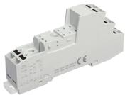
Relais-Stecksocket PRS, für Miniatur-Leistungserelais mit 2-Wechslern, Push-in Anschluss, Steckmöglichkeit für Eingangs-/Entstörmodule und Querverbinder, Montageart: TS 35, Bemessungsquerschnitt: 1,5mm<sup>2</sup>, Bemessungsspannung 300V
