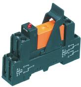
Vormontiertes Relaismodul PRS..., Schraubanschluss, bestehend aus: Relaissockel, Leistungskontaktrelais, steckbarem Anzeige-/ Entstörmodul und Haltebügel, 2 Wechsler, Eingangsspannung: 230 VAC
