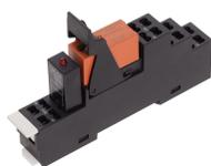
Vormontiertes Relaismodul PRS..., Zugfederanschluss, bestehend aus: Relaissockel, Leistungskontaktrelais, steckbarem Anzeige-/ Entstörmodul und Haltebügel, 2 Wechsler, Eingangsspannung: 230 VAC
