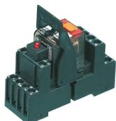
Vormontiertes Relaismodul PRS..., Schraubanschluss, bestehend aus: Relaissockel, Leistungskontaktrelais, steckbarem Anzeige-/ Entstörmodul und Haltebügel, 4 Wechsler, Eingangsspannung: 12 VDC
