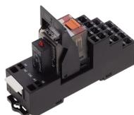
Vormontiertes Relaismodul PRS..., Zugfederanschluss, bestehend aus: Relaissockel, Leistungskontaktrelais, steckbarem Anzeige-/ Entstörmodul und Haltebügel, 4 Wechsler, Eingangsspannung: 12 VDC
