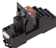
Vormontiertes Relaismodul PRS..., Zugfederanschluss, bestehend aus: Relaissocket, Leistungskontaktrelais, steckbarem Anzeige-/ Entstörmodul und Haltebügel, 4 Wechsler, Eingangsspannung: 24 VDC
