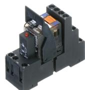
Vormontiertes Relaismodul PRS..., Schraubanschluss, bestehend aus: Relaissocket, Leistungskontaktrelais, steckbarem Anzeige-/ Entstörmodul und Haltebügel, 4 Wechsler, Eingangsspannung: 24 VDC
