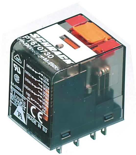
Steckbare Industrirelais mit Leistungskontakten, 4 Wechsler, Prüftaste, mechanische Schaltstellungsanzeige, Eingangsspannung: 24 VAC
