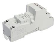
Relais-Stecksocket PRS, für Industrierelais mit 4-Wechslern, Push-in Anschluss, Steckmöglichkeit für Eingangs-/Entstörmodule und Querverbinder, Montageart: TS 35
