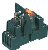
Vormontiertes Relaismodul PRS..., Schraubanschluss, bestehend aus: Relaissocket, Leistungskontaktrelais, steckbarem Anzeige-/ Entstörmodul und Haltebügel, 4 Wechsler, Eingangsspannung: 24 VAC
