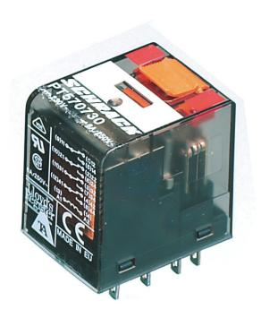
Steckbare Industrierelais mit Leistungskontakten, 4 Wechsler, Prüftaste, mechanische Schaltstellungsanzeige, Eingangsspannung: 230 VAC
