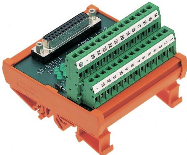
Übergabemodul für D-SUB, Schraubanschluss und female D-SUB-Steckverbinder, Montageart: TS 35, LED Anzeige, Polzahl: 37
