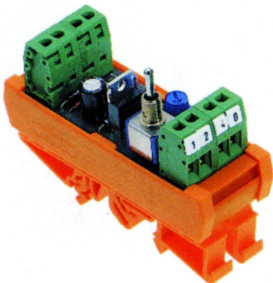
Analoges Ausgabemodul mit Hand-Aus-Automatik Umschaltung, Schraubanschluss, Montageart: TS 35, 1 Kanal, Spannung: 10VDC
