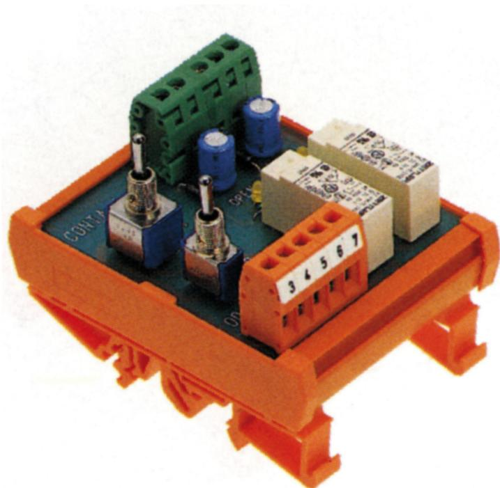
Digitales Schaltmodul mit Hand-Aus-Automatik Umschaltung, zusätzlicher Schalter für Auf-Stop-Zu und Watchdog, Schraubanschluss, Montageart: TS 35, 1 Kanal, Spannung: 24VAC/DC
