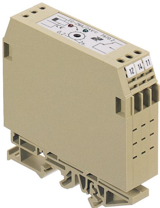
Abfallverzögertes Zeitrelais, Zeitbereich 0,1s - 1s, Schraubanschluss, Montageart: TS 35, 1 Wechsler, Versorgungsspannung: 24 VAC/DC
