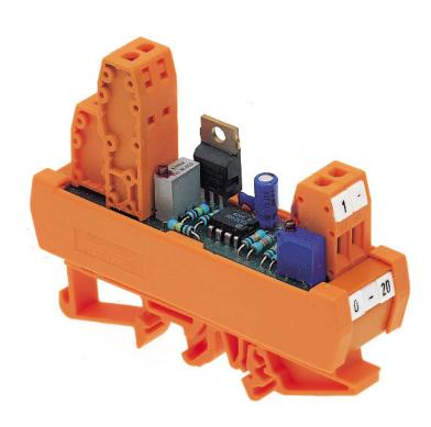
Signalwandler zur Umwandlung von Spannungs/Stromsignalen auf ein analoges Normsignal, Schraubanschluss, Montageart: TS 35, Versorgungsspannung: 24 VDC
