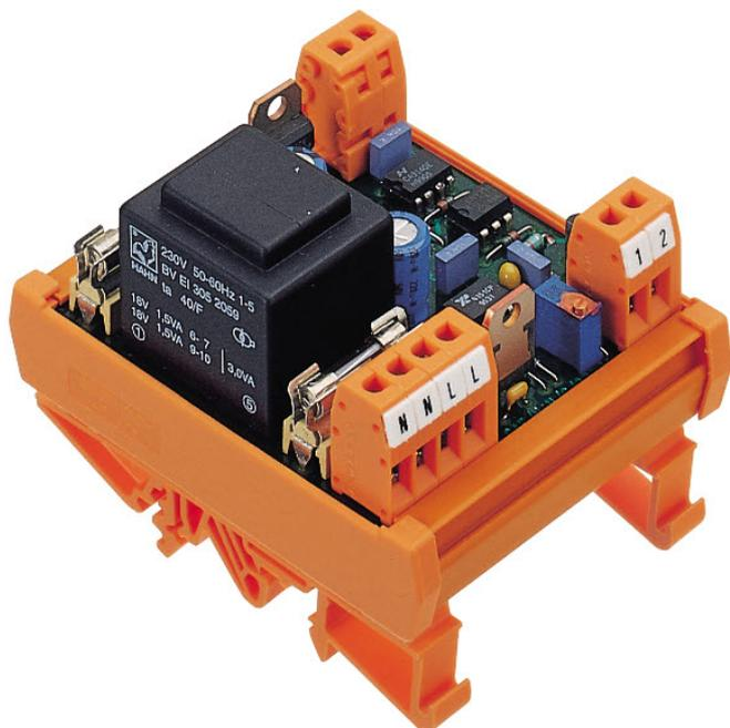
Signalwandler zur Umwandlung von Spannungs/Stromsignalen auf ein analoges Normsignal, galvanische Trennung, Schraubanschluss, Montageart: TS 35, Versorgungsspannung: 24 VDC
